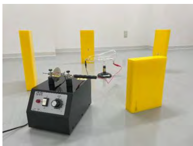
図1 クルックス管からの漏洩X線測定の様子
