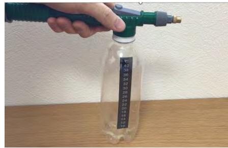
4 加圧時に示度は高くなり減圧時に低くなる
